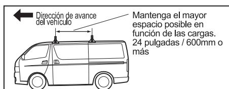
3 Coloque temporalmente 2 barras en las posiciones de montaje en el techo. (24 pulgadas / 600 mm o más para un espacio en la dirección delantera-trasera)
