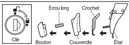
**2** Préalablement à l'installation, déverrouillez le verrou pour desserrer l'écrou long et séparez-le de l'étai, du crochet, du couvercle, de l'écrou long et du bouton.
