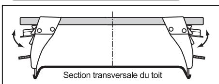
**6** Passez la barre à travers l'étai tout en relevant le levier de fixation de la barre.
