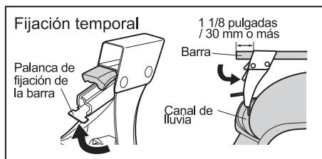
6 Pase la barra a través del soporte mientras levanta la palanca de fijación de la barra.
