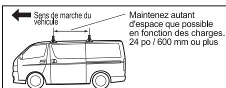
**3** Placez temporairement 2 barres dans les positions de montage sur le toit. (Espace de 24 po / 600 mm ou plus dans la direction avant-arrière)
