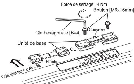
Couvrez la plaque de base montée, placez-y l'unité de base fournie avec le porteur et serrez fermement en alternance les boulons [M6x15]. Vérifiez la direction de l'unité de base.
