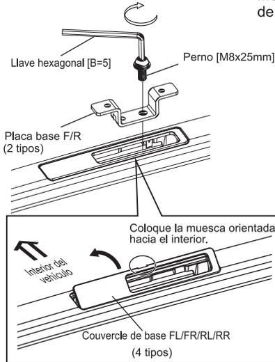
Monte la cubierta de la base, coloque la placa base en la zona de montaje del vehículo y apriete el perno [M8x25] con firmeza.
