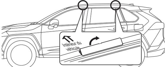
Retirez le couvercle d'installation du porte-bagages situé sur la barre du toit du véhicule.
