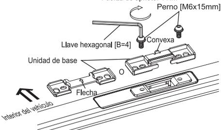
Cubra la placa base montada, coloque sobre ella la unidad de base incluida en la unidad del bastidor y apriete firmemente los pernos [M6 x 15] de forma alterna.
