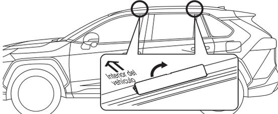
Retire la cubierta de instalación del bastidor situada en el riel del techo del vehículo.
