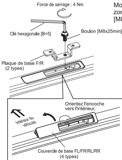
Montez le couvercle de base, placez la plaque de base sur la zone de montage du véhicule et serrez fermement le boulon [M8x25].
