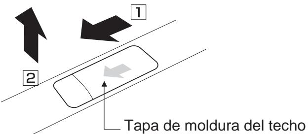
**2** Extracción de las tapas de la moldura del techo
