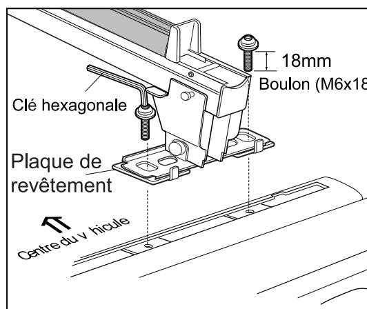
**1** Placez la plaque de revêtement et le porteur sur le plateau-écrou que vous avez inséré sur le longeron de toit original puis, à l'aide de la clé hexagonale, serrez l'un après l'autre les boulons [M6 x 18] de droite et de gauche.
