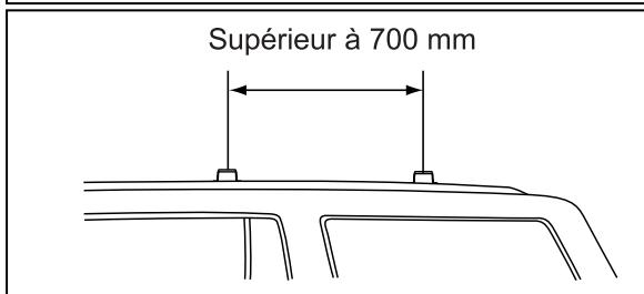
**2** Veillez à laisser une distance supérieure à 700 mm entre les porteurs avant et arrière.
