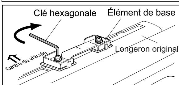
**3** Serrez les boulons, l'un après l'autre, en utilisant la clé hexagonale fournie.
