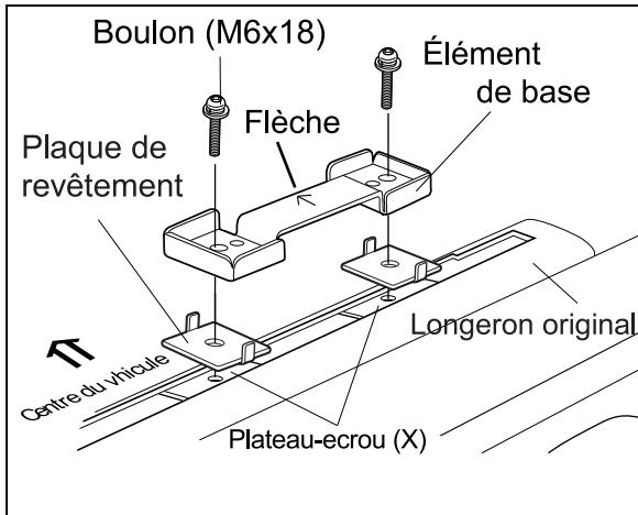
**1** Placez la plaque de revêtement et la base sur le plateau-écrou que vous avez inséré sur le longeron de toit original. Insérez un boulon [M6x18mm] de l'extérieur et fixez-les ensemble sans serrer.
