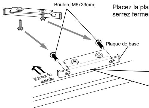
Placez la plaque de base sur le côté intérieur de la barre et serrez fermement les boulons [M6x23] en alternance.
