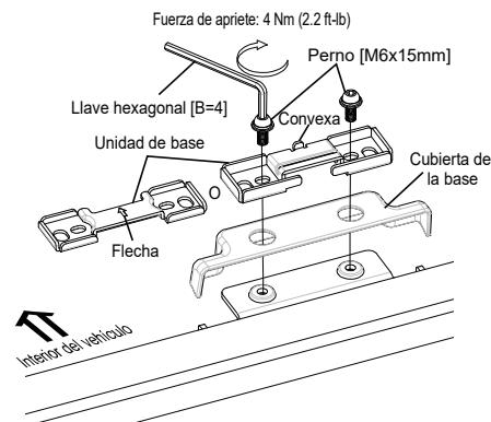
Cubra la placa base montada con la cubierta de la base, coloque sobre ella la unidad de base incluida en la unidad del bastidor y apriete firmemente los pernos [M6 x 15] de forma alterna. Confirme la dirección de la unidad de base.
