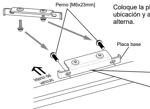
Coloque la placa base desde el lado interno del riel hasta su ubicación y apriete firmemente los pernos [M6 x 23] de forma alterna.
