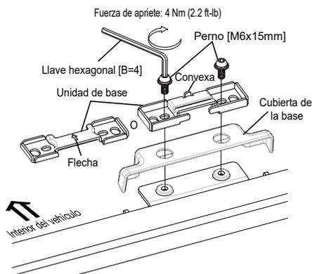
Cubra la placa base montada con la cubierta de la base, coloque sobre ella la unidad de base incluida en la unidad del bastidor y apriete firmemente los pernos [M6 x 15] de forma alterna.
