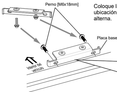
Coloque la placa base desde el lado interno del riel hasta su ubicación y apriete firmemente los pernos [M6x18] de forma alterna.
