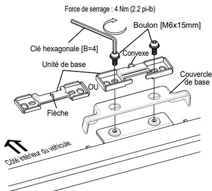
Couvrez la plaque de base montée avec le couvercle de base, placez y l'unité de base fournie avec le corps du porte-bagages et serrez fermement en alternance les boulons [M6x15]. Vérifiez la direction de l'unité de base.
