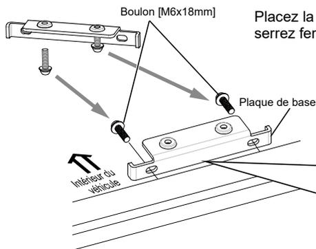
Placez la plaque de base sur le côté intérieur de la barre et serrez fermement les boulons [M6x18] en alternance.
