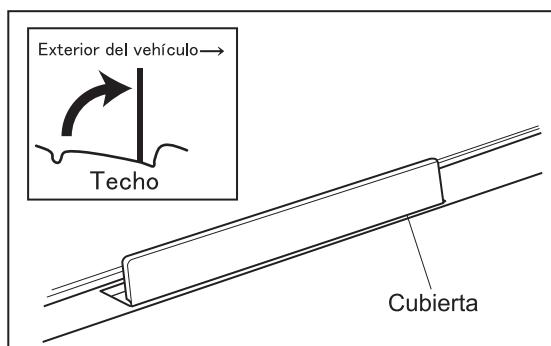
**2 Elevación de la cubierta de las ubicaciones de instalación del portacargas**
