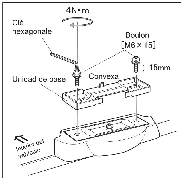
**1** Coloque la unidad de la base en la base del amortiguador / abrazadera de la base que se han instalado. Luego, con la llave hexagonal (incluida), sujetela ajustando de forma alternada los pernos derecho e izquierdo (cortos) [M6x15] (que se incluyen con el portacargas) hasta que los pernos estén bien firmes.
