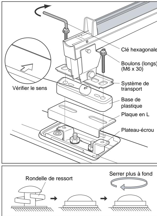
**1** Alignez le trou allongé de la plaque en L et le trou extérieur du système de transport avec le trou du plateau-écrou. Puis, fixez-les au plateau-écrou à l'aide des boulons (courts) (M6 x 15), inclus avec le système de transport.
