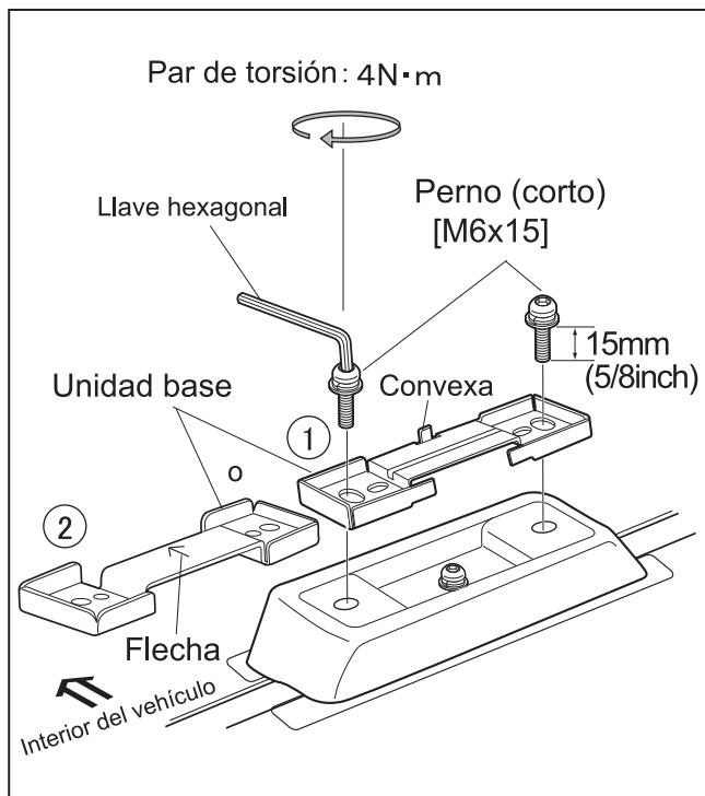
**1** Coloque la unidad de la base en la base del amortiguador / abrazadera de la base que se han instalado. Luego, con la llave hexagonal (incluida), sujetela ajustando de forma alternada los pernos derecho e izquierdo (cortos) [M6x15] (incluidos) hasta que los pernos estén bien firmes.
