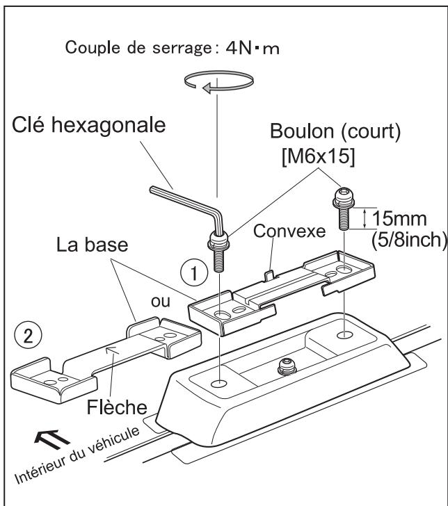
**1** Positionnez l'élément de base sur l'ensemble base de coussinet / support de base. Puis, en utilisant la clé hexagonale (fournie), serrez les boulons courts [M6x15] (fournis) en alternant les boulons du côté droit et ceux du côté gauche, jusqu'à ce qu'ils soient bien serrés.
