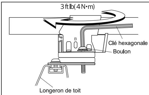
**8** Serrer alternativement les boulons de droite et de gauche avec la clé hexagonale incluse jusqu'à ce qu'ils soient fermement fixés, puis fixer l'étais au longeron du toit.
