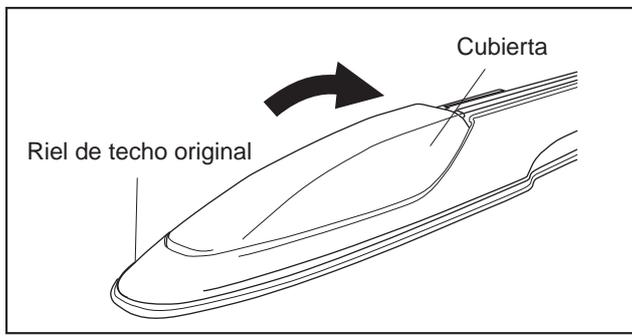
**3** Abra la cubierta de la parte delantera del riel de techo.
