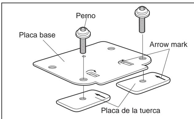
**2** Atornille ligeramente la placa de tuerca y la placa base con el perno [M6x15mm]. Asegúrese de que las marcas de flecha de la placa base y de la placa de tuerca apunten hacia arriba.
