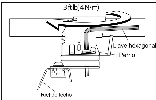
**8** Ajuste el perno derecho y el izquierdo alternativamente con la llave hexagonal incluida hasta que queden firmemente fijos, y fije el soporte a la barra portaequipaje.
