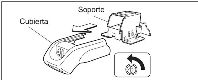
**1** Quite el seguro del soporte básico TR y retire las cubiertas de los soportes.
