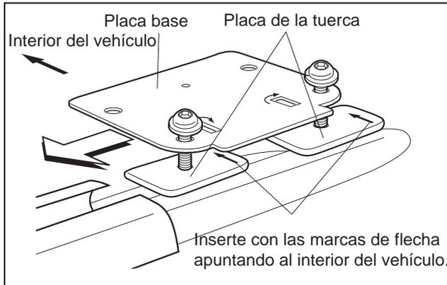
**4** Desde la parte delantera del riel de techo, deslice la placa base ensamblada ligeramente e inserte la placa de tuerca en la ranura del riel de techo como se ilustra. Asegúrese de insertar la placa de tuerca con las marcas de flecha apuntando hacia el interior del vehículo.
