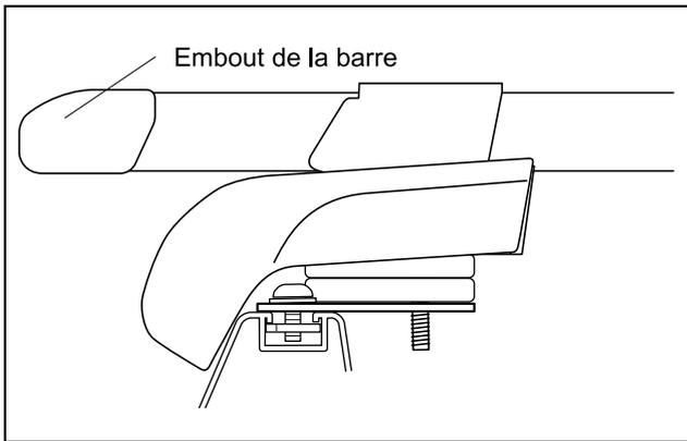
**11** Installez les embouts de barre (fournis avec l'ensemble de barres).
