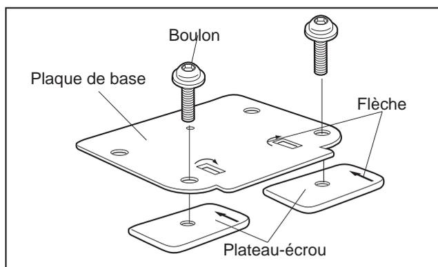
**2** Vissez le plateau-écrou à la plaque de base sans serrer à l'aide des boulons [M6 x 15 mm].
