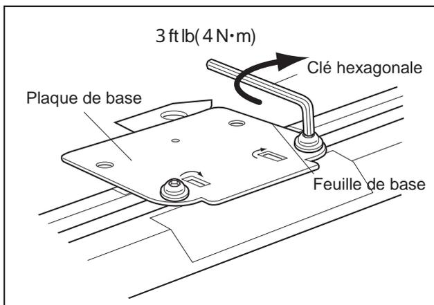
**5** Tout en surélevant légèrement la plaque de base, la faire coulisser jusqu'à l'emplacement où est attachée la feuille de base, puis la serrer à l'aide de la clé hexagonale incluse jusqu'à ce qu'elle soit fermement fixée.
