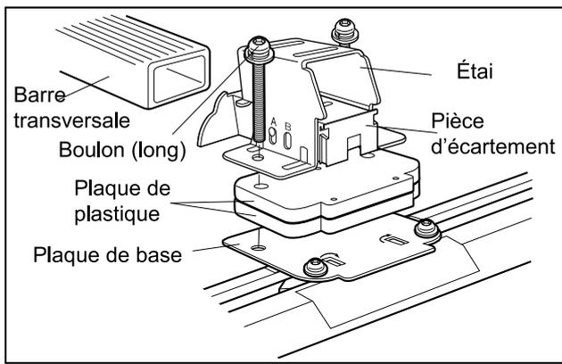
**7** Disposer 2 plaques de plastique sur la plaque de base. Disposer l'étais sur les couches de plaques de plastique et la plaque de base et assembler l'ensemble sans trop serrer à l'aide de 2 longs boulons [M6x35mm] comme illustré. Placez les barres transversales à travers les étais assemblés.
