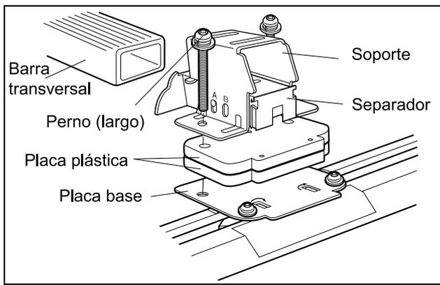
**7** Ubique 2 placas plásticas en la placa base. Ubique el soporte sobre las capas de placas plásticas y la placa base y fíjelas todas juntas con poca firmeza usando 2 pernos largos [M6x35mm] como se ilustra.
