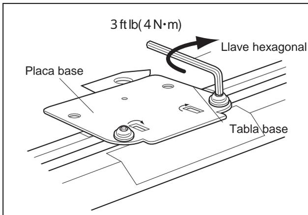
**5** Mientras levanta un poco la placa base, deslícela hasta la posición donde está sujeta la tabla base, y ajústela con la llave hexagonal incluida hasta que quede firmemente fija.
