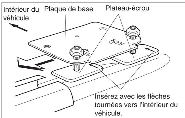
**4** Faites glisser, à partir de l'avant du longeron de toit, la plaque de base assemblée de manière lâche et insérez le plateau-écrou dans la rainure du longeron, tel qu'illustré. Assurez-vous d'insérer le plateau-écrou de manière à ce que les flèches soient tournées vers l'intérieur du véhicule.
