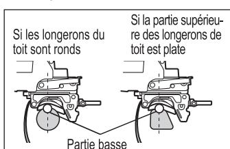
⑦ Réglez la position du porteur de manière à ce que les fixations puissent reposer entre les porteurs avant et arrière.
