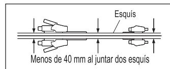
Si las ataduras de los esquís o tablas de snowboard no caben entre los portacargas delantero y trasero, colóquelos de forma que una de las ataduras quede por delante del portacargas delantero. Si se produce esta situación, no vaya a más de 50 mph (80 Km/h).
