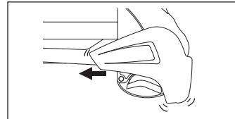
Insérez le couvercle de porteur fermement aussi loin que possible. S'il n'est pas fermement inséré, le couvercle de porteur émettra des cliquetis. Si le couvercle de porteur émet des cliquetis, insérez à nouveau correctement le couvercle.
