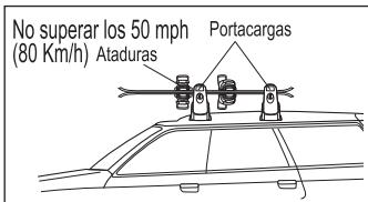
Si las ataduras de los esquís o tablas de snowboard no caben entre los portacargas delantero y trasero, colóquelos de forma que una de las ataduras quede por delante del portacargas delantero.
