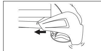
Coloque la cubierta del portacargas con firmeza hasta el fondo. Si no queda firme, la cubierta hará ruido. En este caso, vuélvala a montar correctamente.
