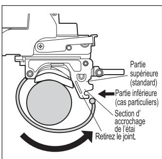
Si la sangle multiple est étirée à sa longueur maximum et n'est toujours pas assez longue, enlevez le joint et accrochez la sangle sur le niveau inférieur de la section d'accrochage.
