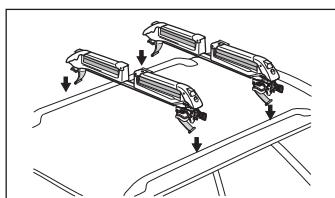
⑥ Alignez la partie basse de la section de base de l'étaï au centre du longeron de toit et placez le porteur sur les rails.
