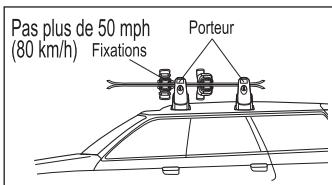
Si les fixations de ski ou de snowboard ne passent pas entre les porteurs avant et arrière, arrangez-vous pour que l'une des fixations soit à l'avant du porteur avant. Dans ce cas, ne dépassez pas 50 mph (80 km/h).
