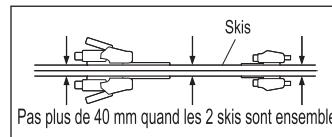
Si les fixations de ski ou de snowboard ne passent pas entre les porteurs avant et arrière, arrangez-vous pour que l'une des fixations soit à l'avant du porteur avant. Dans ce cas, ne dépassez pas 50 mph (80 km/h).
