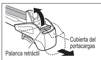
Una vez desmontada la cubierta se puede acceder al soporte del portacargas.
