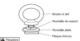
Passez la rondelle de ressort avant la rondelle plate.
