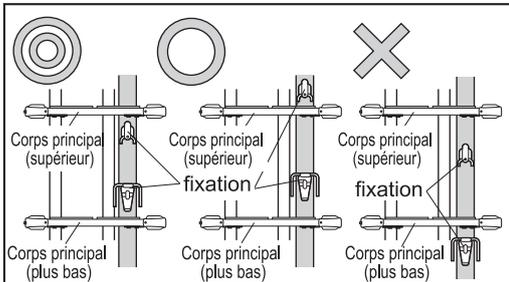
3. Fixez le ski avec les fixations du ski placées entre la fixation supérieure et la fixation inférieure. Si la fixation du ski est trop grande, remontez le ski.
