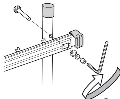
Serrez jusqu'à ce que la rondelle de ressort soit complètement plate.
