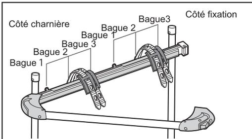
1. Placez les bandes de caoutchouc sur chaque bague du côté charnière et du côté fixation.
