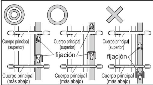
3. Sujete el esquí mientras las fijaciones del esquí se encuentran entre el aditamento superior y el aditamento inferior. Si la fijación es demasiado larga, desplace el esquí hacia arriba.
