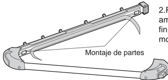
2. Retire el burlete de hule a ambos puntos de montaje a fin de que los orificios de montaje queden expuestos.
