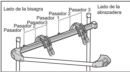
1. Coloque las bandas de hule en cada pasador del lado de la bisagra y del lado de la abrazadera.
