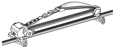
Installation du système de transport sur des barres transversales carrées achetées ultérieurement.
