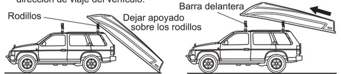
**12** Alce ligeramente la embarcación en la barra delantera y ajuste el sujetador de la borda de 5 a 10 mm (de 0.2" a 0.4") aprox. de la embarcación.
