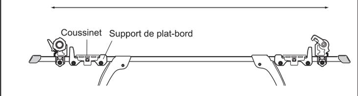
**10** Abaissez les butées sur les deux bases de galet (côté rochet et côté crochet) pour que les galets puissent tourner librement lors du chargement.
