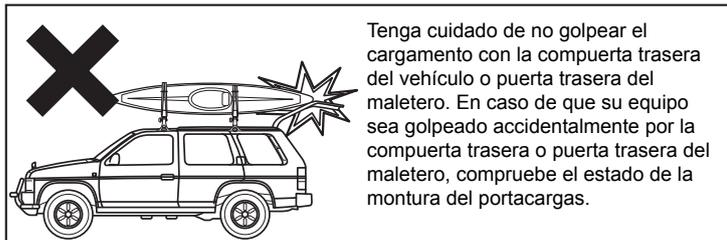
Tenga cuidado de no golpear el cargamento con la compuerta trasera del vehículo o puerta trasera del maletero. En caso de que su equipo sea golpeado accidentalmente por la compuerta trasera o puerta trasera del maletero, compruebe el estado de la montura del portacargas.
