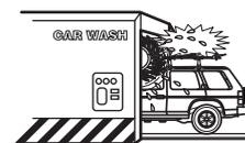
Retire el portacargas antes de usar un servicio de lavado automático de automóviles. Verifique la condición del aditamento en caso de usar un lavado automático en forma accidental. Es posible que el portacargas o el vehículo se dañen al usar un servicio de lavado automático, si no lo retira.
