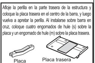
Afloje la perilla en la parte trasera de la estructura y coloque la placa trasera en el centro de la barra, y luego vuelve a apretar la perilla. Al instalarse sobre barra en cruz, coloque cuatro engomados de hule (s) sobre la placa y un engomado de hule (m) sobre la placa trasera.
